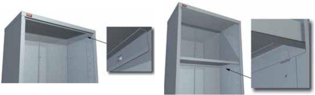
8. Вставить втулки дверных осей и ригелей в соответствующие отверстия в дне и крыше (рис.8)
