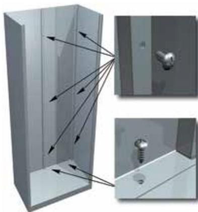
6. Установить крышу . При установке крыши боковые и задние стенки должны располагаться между внутренними боковыми поверхностями крыши и угловыми профилями. Крышу опустить вниз до защелкивания замков боковых стенок в отверстиях угловых профилей крыши. (рис. 6)
