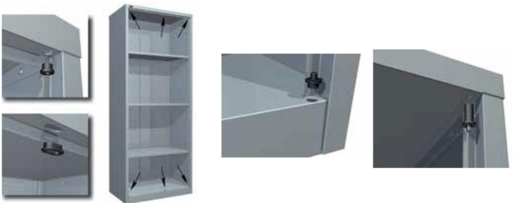
11. Совместить отверстия в верхней части двери с отверстием втулки крыши, вставить ось и зафиксировать ее, загнув лепесток кронштейна. (рис. 11)
