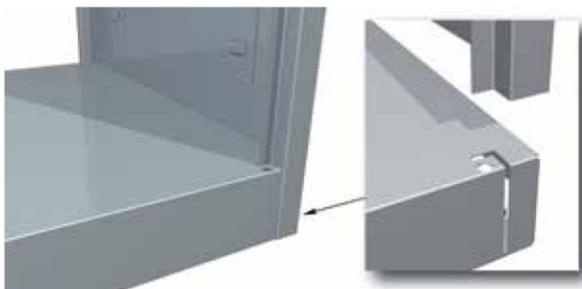
2. Прикрепить боковую стенку к дну двумя саморезами (рис. 2)
