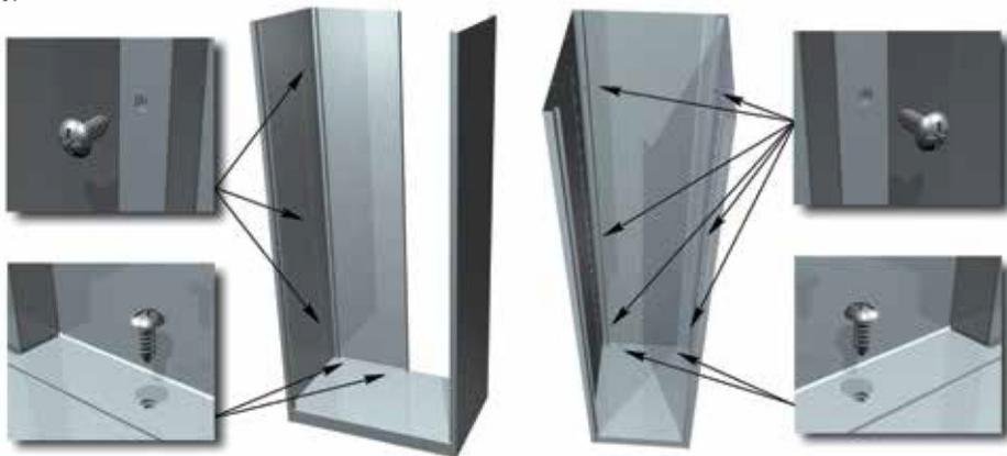
5. Установить правую заднюю стенку , соединив ее с правой боковой стенкой с помощью трех саморезов , с левой задней стенкой – спомощью трех саморезов и с дном – с помощью двух саморезов. (рис. 5)
